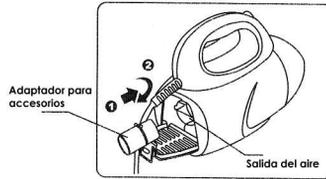
b. Conecte el adaptador para el tubo de aire y gírelo en el sentido de las agujas del reloj hasta que este bien sujeto.
